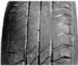
Sie müssen die Reifen auswechseln, wenn diese die Mindestprofiltiefe, die durch die Verschleißindikatoren angezeigt wird, erreicht haben. Außerdem können Ihre Reifen noch eine anormale Abnutzung aufweisen.
