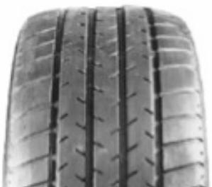
Ein Unterdruck im Reifen führt häufig zu einer ausgeprägteren Abnutzung an den Reifenschultern. Beim Fahren mit nicht ausreichend aufgepumpten Reifen verringern Sie nicht nur die Lebensdauer des Reifens, sondern verbrauchen noch mehr Kraftstoff durch einen höheren Rollwiderstand (bei weichen Reifen muss das Fahrzeug höhere Leistungen aufbringen). Eine anormale Abnutzung kann auch auf eine falsche Spureinstellung oder auf ein mechanisches Problem zurückzuführen sein.
