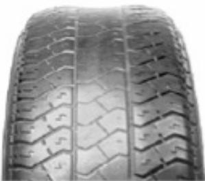
Ein Überdruck im Reifen führt zu einem größeren Verschleiß in der Mitte der Lauffläche, wodurch sich die Lebensdauer des Reifens verringert. Überprüfen Sie bitte den Reifendruck einmal im Monat. Eine anormale Abnutzung kann auch auf eine fehlerhafte Ausrichtung oder auf ein mechanisches Problem zurückzuführen sein.
